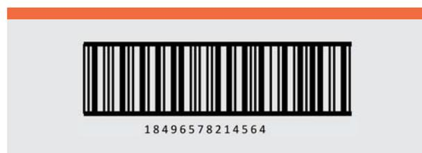
**Figura 3.** Símbolo ITF-14 con barras superior e inferior del marco de impresión.
