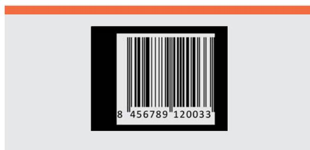
Figura 18. Margen claro derecho insuficiente
