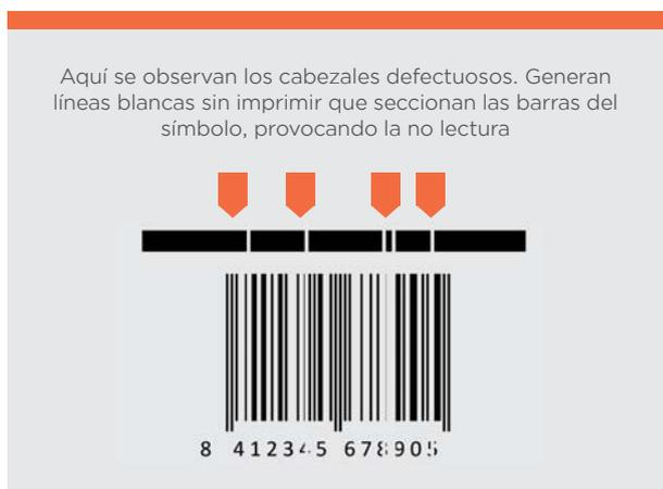
Figura 20. Ejemplo de cabezal de impresión defectuoso
