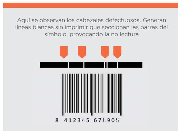
**Figura 6.** Ejemplo de cabezal de impresión defectuoso
